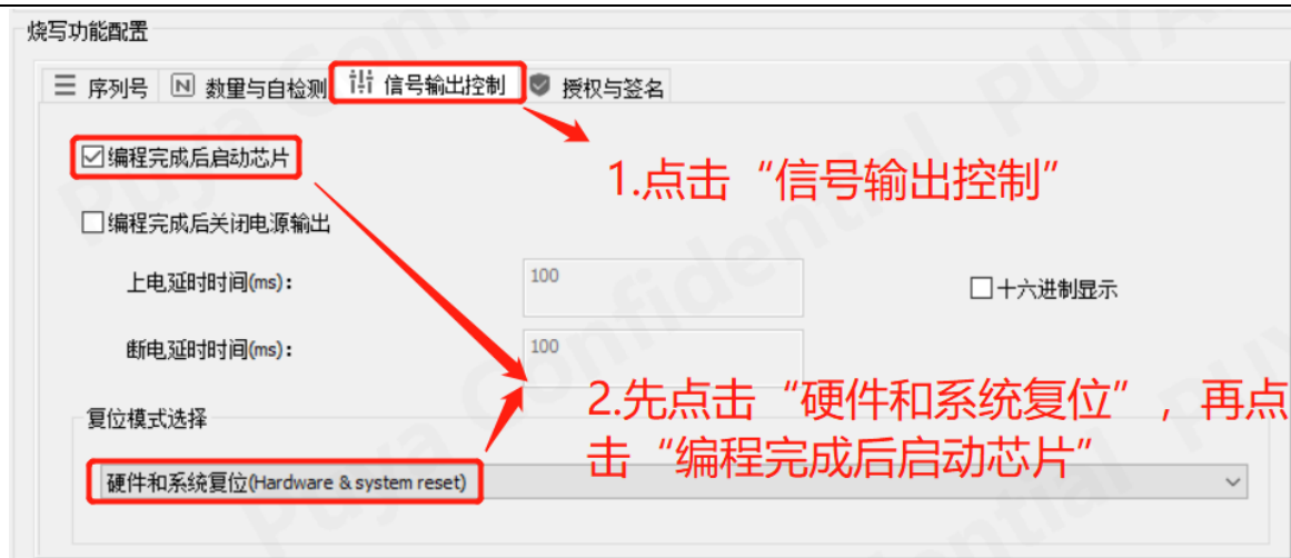
图 10-3 创芯工坊操作勾选“编程后重启芯片”
